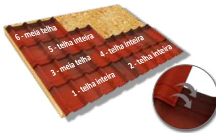
2. Comece a instalação pelo beiral, na direção oposta ao vento predominante. Posicione a faixa escura para cima. Disponha as filas alternadamente, começando a segunda fila com meia telha. As sobreposições laterais são de uma onda. Garanta uma impermeabilização adequada alinhando as zonas de sobreposição.
