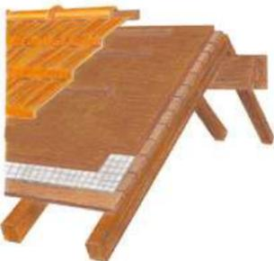
3. No caso de existir algum elemento saliente, corte a ONDUTISS® AIR no sentido da largura e vire para cima, de modo a ficar sobre os elementos salientes (chaminés, ventiladores, janelas, etc.).
