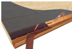
**1.** Instalação em estrutura contínua; inclinação mínima 18°. Revista a estrutura com uma base de feltro, fixada com pregos galvanizados de cabeça larga.
