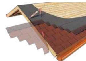
**2.** Fixe a BARDOLINE® usando pregos galvanizados de cabeça larga com comprimento mínimo de 20 mm. Una e sele as peças reauecendo os pontos termoadesivos localizados entre as extremidades exteriores. No tempo frio, fortaleça a colagem aplicando mástique betuminoso.
